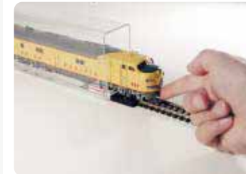
Beim Passieren des Gleisübergangsstücks (GU) werden die Räder zum Lauf auf dem Spurrkranz angehoben, um das manuelle Ein- und Ausschleiben von Lokomotiven mit Haftreifen zu erleichtern.
